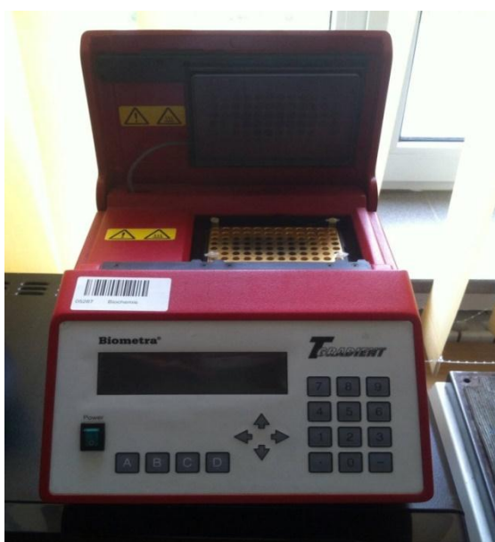
Figura 13. Termociclorul Biometra T Gradient utilizat în reacția de amplificare a genelor de interes
