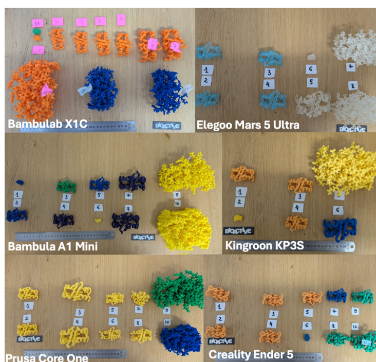
Figura 2. Testarea printabilității diverselor tipuri de reprezentări moleculare oferite de scriptul 3DP-Jmol pe imprimante diverse. Reprezentări moleculare testate: balls and sticks , backbone , trace , cartoon , surface . Numerele indică poziția respectivului model în coloana NR asociată fiecărei imprimante din Anexa 2 .
