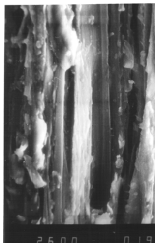
Fig. 8. Tei în permetrină cu shellsol (2600x)
